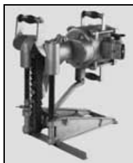
Bild 1.1: Die erste tragbare elektrische Zimmereimaschine der Welt (Type A von Mafell 1926) 1
