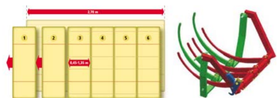
Abbildung 2.3 Krone MultiBale: 6 kleine Ballen in einem großen, geteilte Nadelschwinge (verändert nach Krone 2003: 10, 11)
