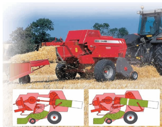
Abbildung 1.3 MF 1839 mit Center-Line-Technologie (verändert nach Massey Ferguson 2007: 2, 3)
