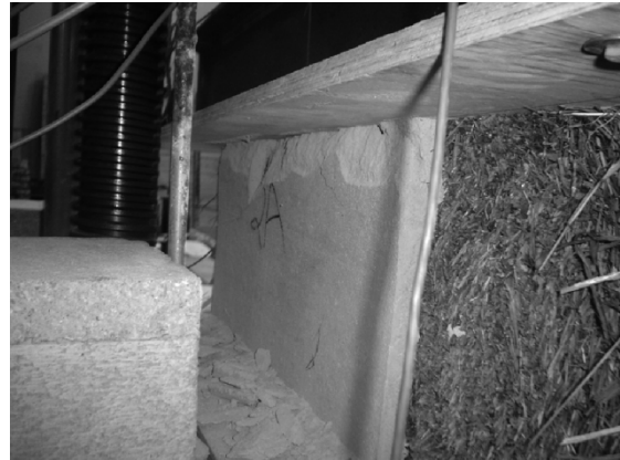
Abbildung 9.2: Typisches Versagen eines flach liegenden Ballen (Vardy/MacDougall 2006: 7)
