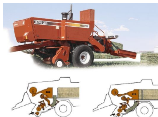
Abbildung 3.4: Hesston 4690S (verändert nach Hesston: 2, 8)
