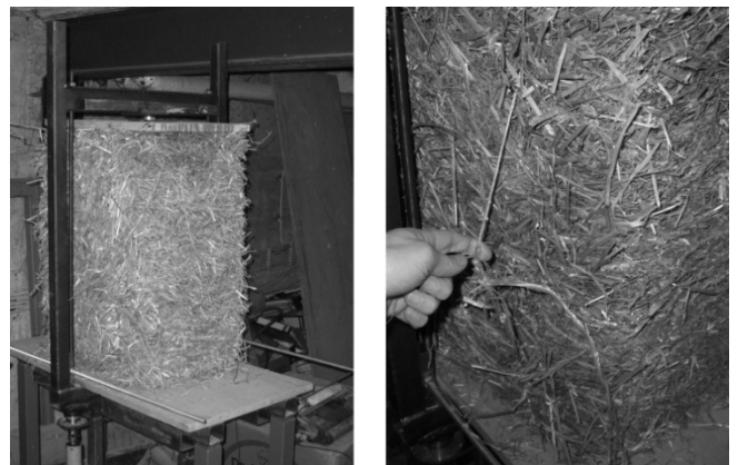
Abbildung 2.31: Probe 1.5.3.1 vor dem Test und entspanntes Ballengarn nach dem Test (Probe 1.5.3.3)
