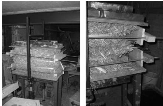
Abbildung 2.25: Probe 1.4.17.1 vor- und verbiegen der Strohhalme nach dem Test
