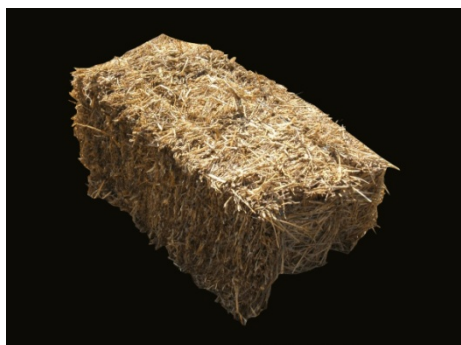
Abbildung 4.6 Bei dichten Ballen mit scharfen Kanten ist die Vorbereitung deutlich weniger aufwändig.
