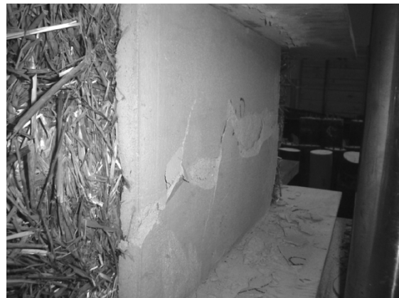
Abbildung 9.3: Typisches Versagen eines hochkant liegenden Ballens (Vardy/MacDougall 2006: 8)
