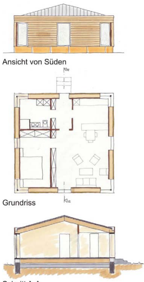
Abbildung 6.1: Skizzen zu dem beschriebenen lasttragenden, eingeschossigen Gebäude
