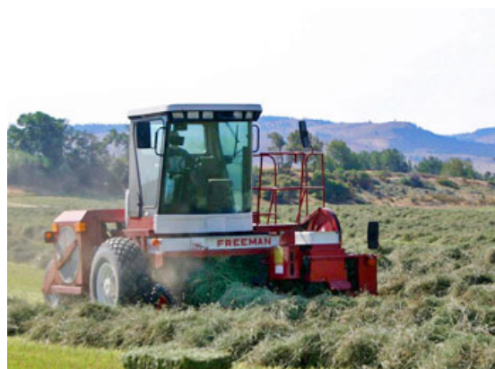
Abbildung 3.1: Selbstfahrende Freeman-Ballenpresse (freeman.com, Zugriff am 9.07.2007)
