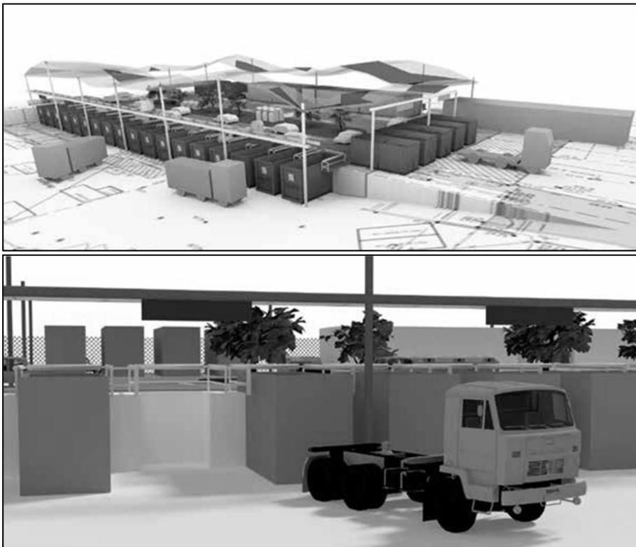
Abbildung 10 a und b: Recyclingpark – Trennung von Kunden- und LKW-Abholverkehr
