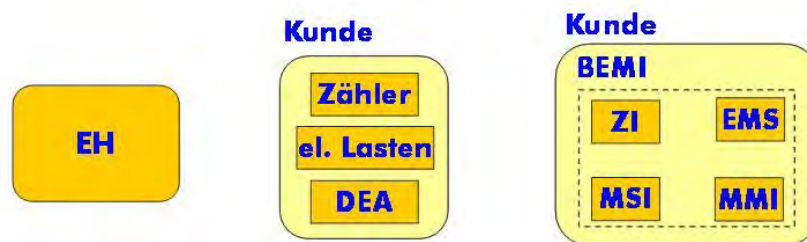
Abbildung 3.2: Beispiele für die grafische Darstellung von Marktteilnehmern ohne und mit technischen Einrichtungen sowie mit technischen Einrichtungen, die zu einer Baugruppe gehören
