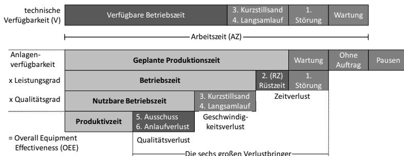
Abbildung 6.1: Die sechs Verlustbringer der OEE-Kennzahl (vgl. Erlach 2010, S. 71)
