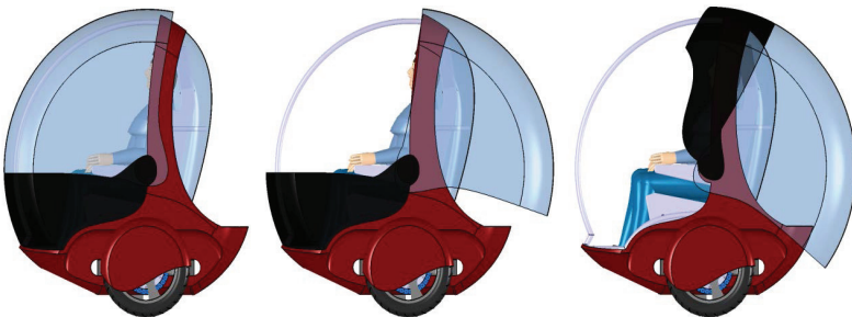
Abb. 3.7: Öffnungsmöglichkeiten der zweigeteilten Scheibe für den Ein- und Ausstieg nach /FUC 12a/
