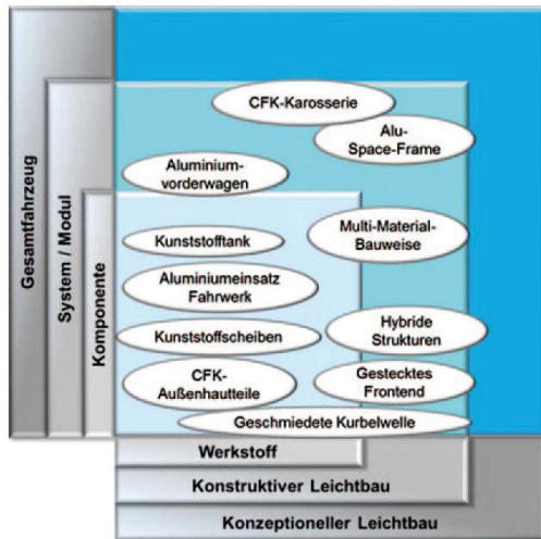
Abb. 2.7: Übersicht möglicher Leichtbaumaßnahmen am Elektrofahrzeug nach /ECK 10/
